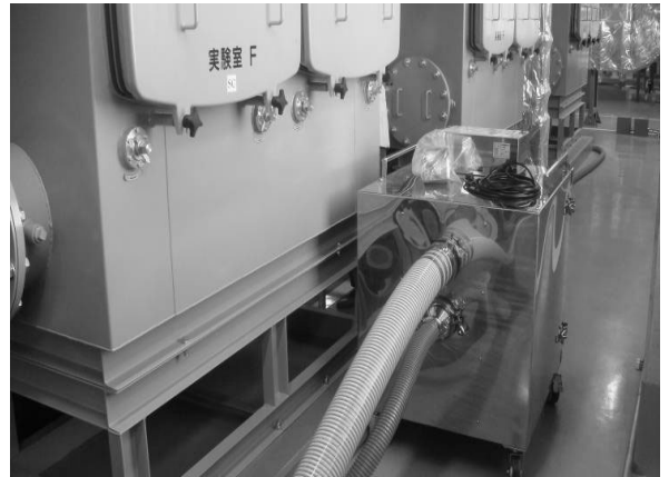
圖二十、福馬林煙薰器，大管子接於實驗室主體供氣管道，小的紅色管子則接在緩衝區。
