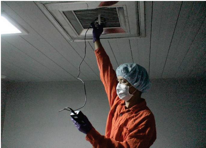
圖 3、換氣次數檢測情形
