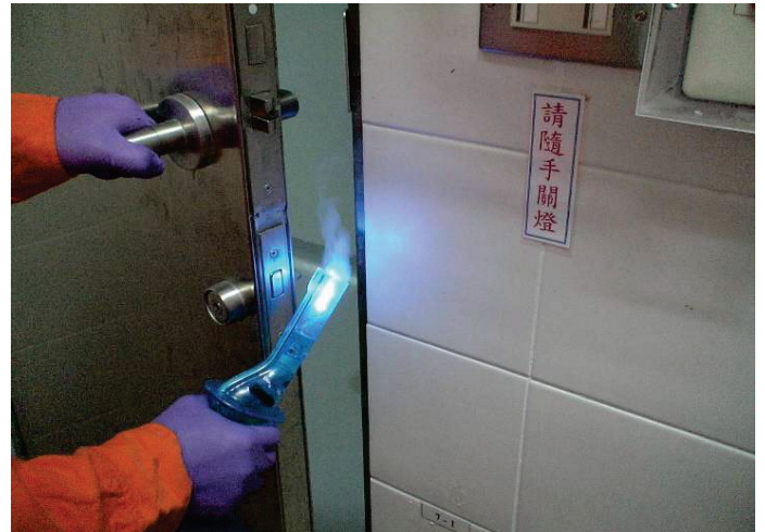
圖 4、空氣流向測定情形
